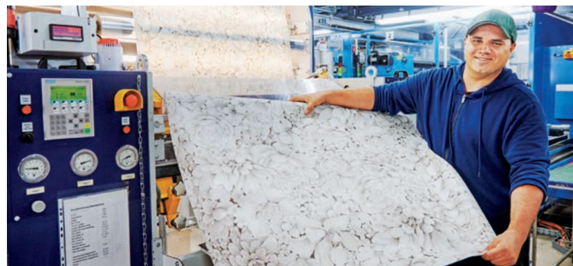
Qualitätsprüfung: Drucker Sven Hartmann begutachtet eine frisch gedruckte Strukturtapete – deren Blumenmuster dank Heißprägung erst richtig zur Geltung kommt.
