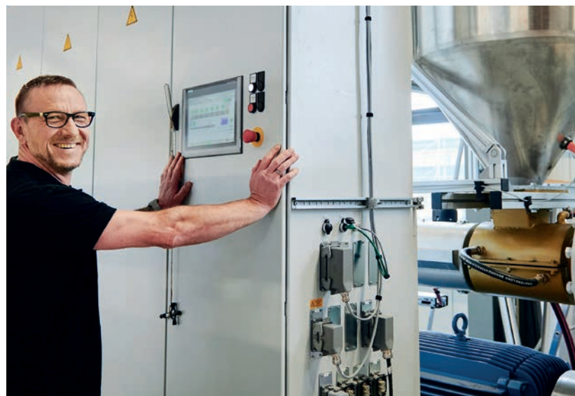
Spezielle Technik: Maschinenführer Georg Stamp bedient die Anlage fürs Schmelzen des Granulats, das als heißsiegelfähiger Kleber auf Papierbahnen aufgebracht wird.
